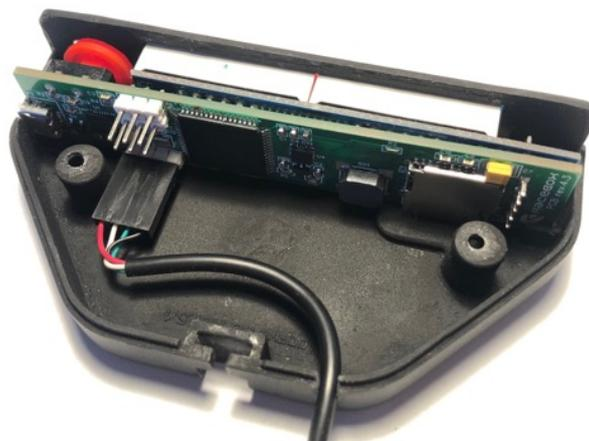
5. Включите устройство и убедитесь, что связь прибора с модулем установлена. Прибор должен показывать сообщение **-NO GPS-** (если плохие условия приёма) или отображать данные о количестве найденных спутников
